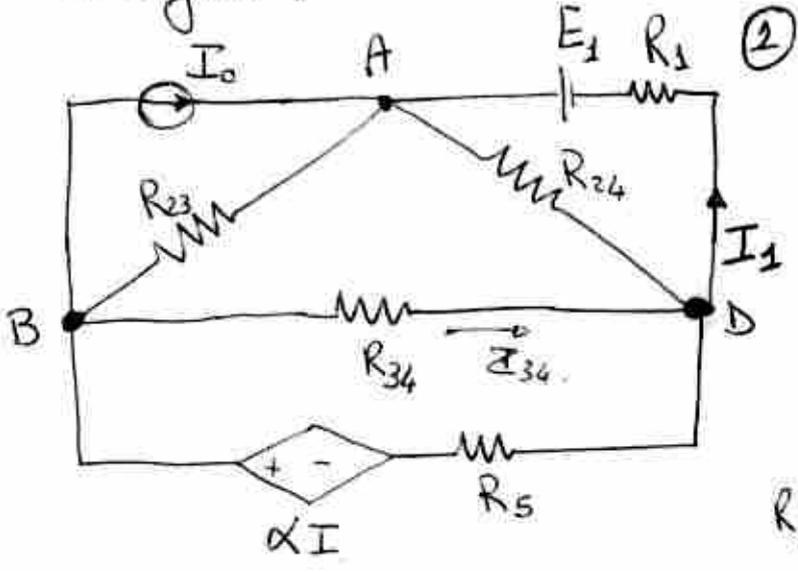
$$R_{23} = \frac{R_2 \cdot R_3 + R_2 \cdot R_4 + R_3 \cdot R_4}{R_4} =$$
