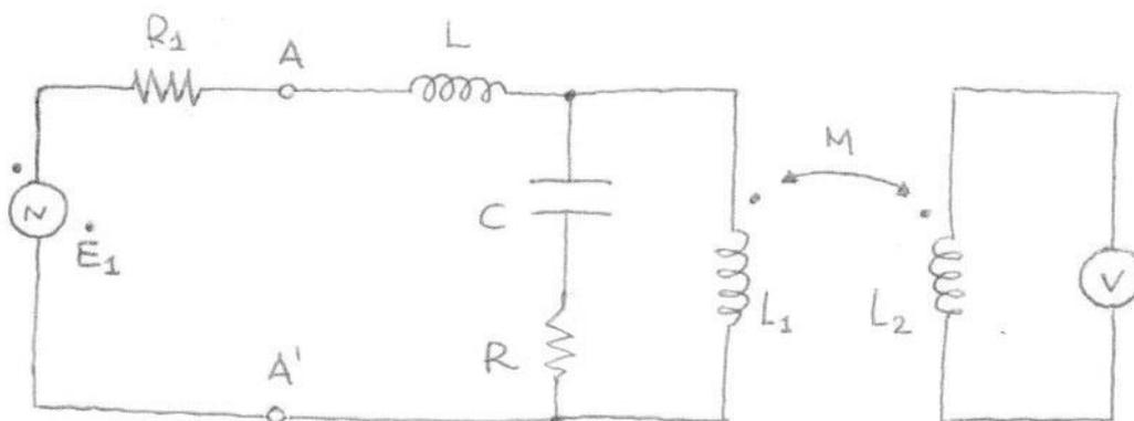
2. Dato il circuito in figura, determinare l'equazione le cui soluzioni rappresentano le frequenze di risonanza della rete vista dal generatore.
