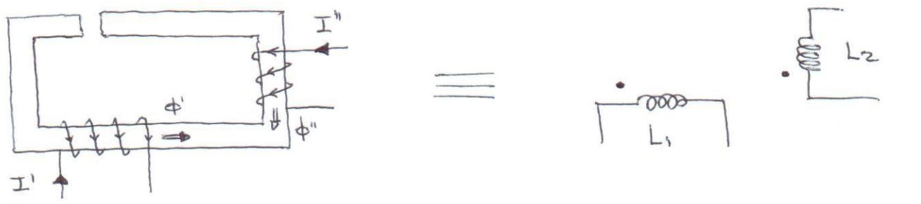
Per il calcolo dei coefficienti di auto-induzione  $L_1$  e  $L_2$  e di mutua induzione  $M_{12} = M_{21} = M$  devo calcolare le riluttanze equivalenti viste dalle bobine.
