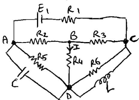
L si compone da c.c. e quindi R6 si può trascurare in quanto parallelo ad un corto circuito.
