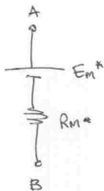
$$EM^* = \frac{\frac{EM_1}{RM_1 + R_3} + \frac{EM_2}{RM_2 + R_4}}{\frac{1}{RM_1 + R_3} + \frac{1}{R_5} + \frac{1}{R_4 + RM_2}}$$
