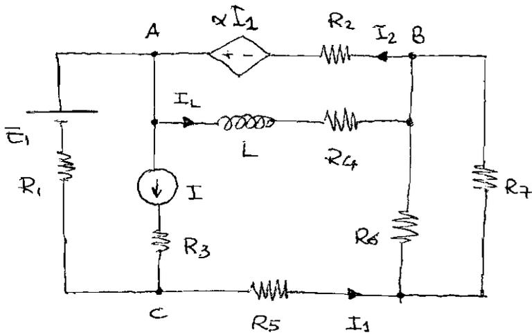
L'energia immagazzinata nell'induttore è  $W_L = \frac{1}{2} L I_L^2$
