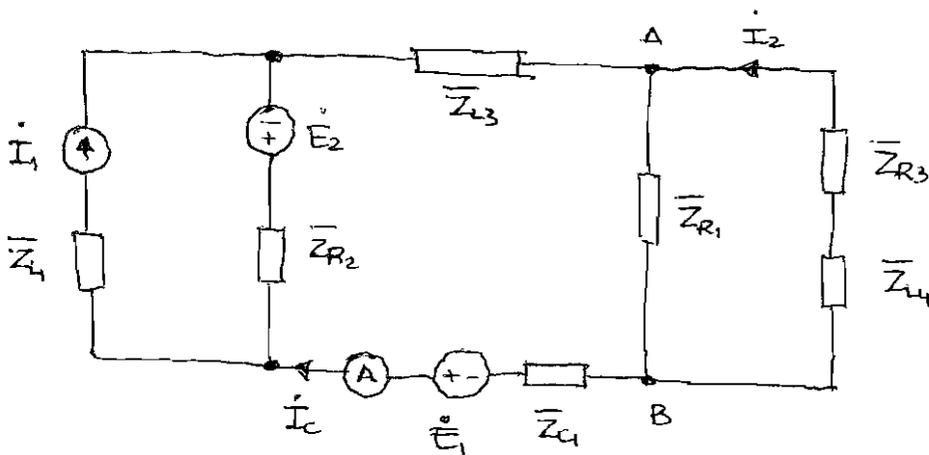
Applichiamo Millman ai due rami  $\dot{I}_1 - \bar{Z}_4$  e  $\dot{E}_2 - \bar{Z}_{R2}$ :
