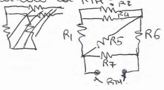
$$R_S = \left[ (R_2 // R_4) + R_1 \right] // R_5$$
