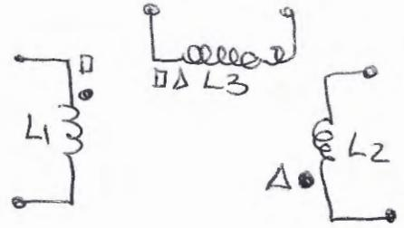
Non è necessario determinare  $L_3$  in quanto il voltmetro si compone da c.a., essendo ideale, quindi su  $L_3$  non scorre corrente  $I_3 = 0$ .
