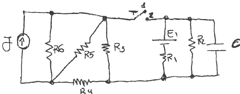
**ES.2** – Dato il circuito in figura, determinare il valore della tensione misurata dal voltmetro ideale e i valori di tutte le correnti che interessano il circuito.
