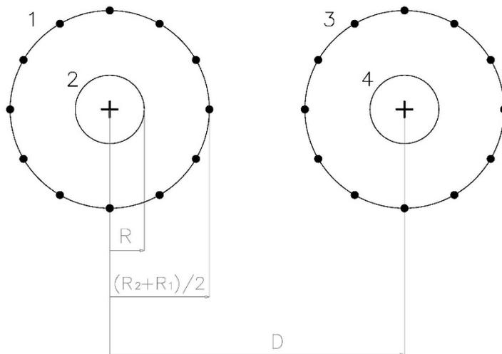
Fig. 6 – Linea costituita da due cavi coassiali con guaina di spessore nullo
