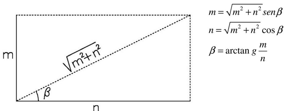
Figura 2 – Relazioni trigonometriche per il calcolo delle componenti armoniche
