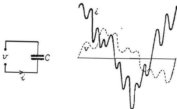
*L'impedenza del circuito diminuisce col crescere della frequenza; perciò l'ampiezza delle armoniche superiori della corrente sta all'ampiezza delle corrispondenti armoniche della tensione in un rapporto progressivamente crescente.*
