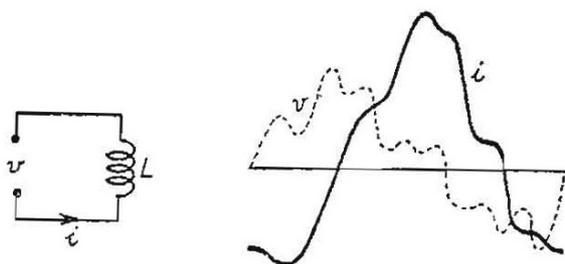
*L'impedenza che il circuito presenta alle varie armoniche, cresce col crescere della frequenza; perciò le armoniche superiori incidono sulla curva della corrente in misura progressivamente più piccola di quella con cui incidono sulla curva della tensione.*
