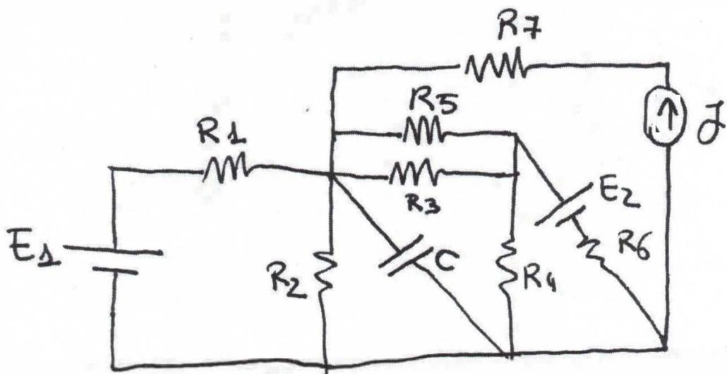
**ES.2** – Il sistema si trova a regime. Determinare il valore della potenza attiva e reattiva tra la sezione A-B e l'espressione temporale della corrente che scorre nel carico C-R<sub>2</sub>.
