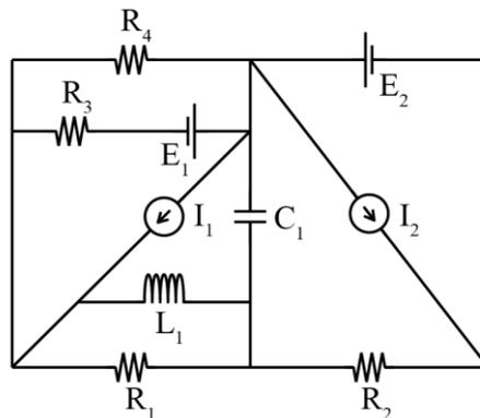
**ES.2** – Dato il circuito in figura, determinare la corrente misurata dall'amperometro ideale.
