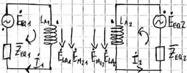
$$\begin{cases} \dot{E}_{EQ1} + \dot{E}_{LA1} + \dot{E}_{M21} = \bar{Z}_{EQ1} \dot{I}_1 \\ \dot{E}_{EQ2} + \dot{E}_{LA2} + \dot{E}_{M12} = \bar{Z}_{EQ2} \dot{I}_2 \end{cases}$$
