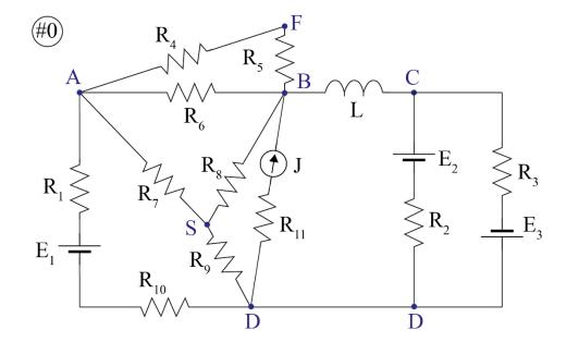
Il sistema è a regime quindi l'induttore L si comporta da cortocircuito.  $R_{11}$  è trascurabile perché in serie ad un generatore di corrente. Collegamento serie tra  $R_1$  e  $R_{10}$ .
